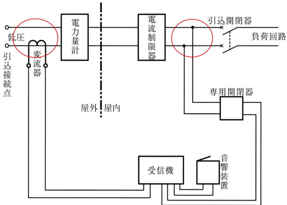
変流器に警戒電路のうちの1線しか貫通させていない。
