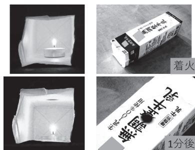
写真1 牛乳パック内でのろうソク燃焼
