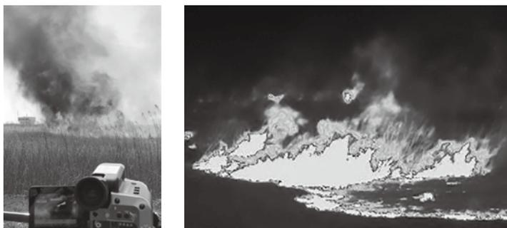
図4：サーモカメラで野焼きにおける燃え拡がり撮影した熱画像（渡良瀬遊水地ヨシ焼きにて）
