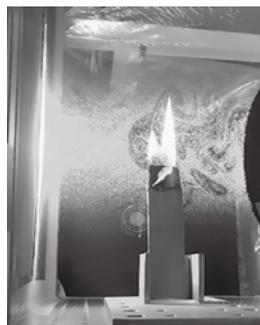
図1：PIVの機器配置とPIVによる火炎とその周辺気流の可視化計測の様子（西華デジタルイメージ株式会社の計測室にて）
