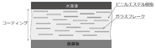
図1 ビニルエステル樹脂系ガラスフレークコーティングの断面模式図
