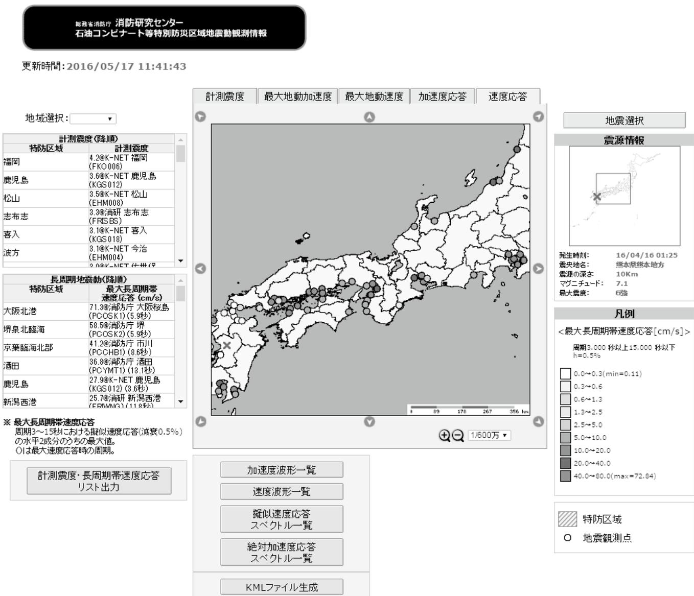
図2 「石油コンビナート等特別防災区域地震動観測情報システム」。平成28年熊本地震の際の表示画面。この図では、長周期地震動レベルの指標として示している周期3~15秒における疑似速度応答の最大値の分布が示されている。
