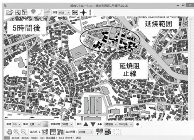
図4 延焼阻止線を設定後の延焼予測結果
